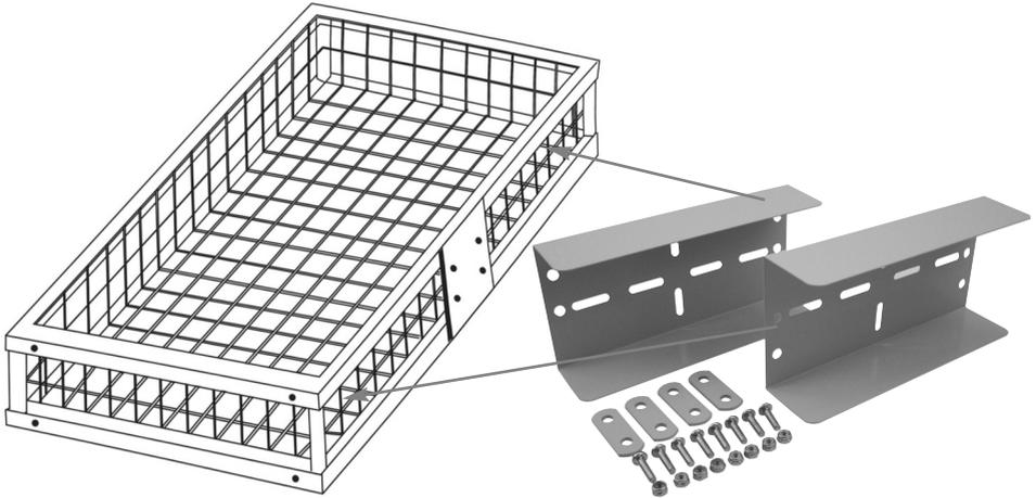
1. Befestigen Sie die beiden Beleuchtungshalter mit den beiliegenden Schrauben und Muttern, rechts und links am Heckträger.
